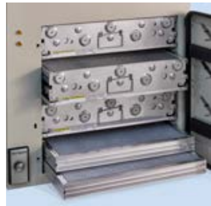
MistBuster® mit 5 Filterstufen
